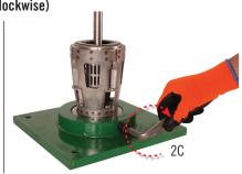
3 Place BOTTOM STAGE IMPELLER on Shaft
